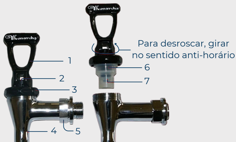
1. Alavanca; 2. Eixo da Alavanca; 3. Porca; 4. Corpo da Torneira; 5. Reparo de Silicone; 6. Mola interna ao reparo
